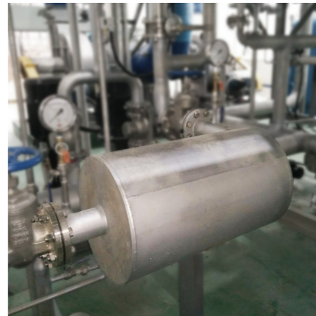
* VAF-MIXER : 유체 원심력과 강력한 와류를 이용하여 저전력, 낮은 압력 조건 하에서 공기를 비롯한 다양한 기체(CO 2 , O 3 , O 2 , N 2 등)들을 용해하는 장치
